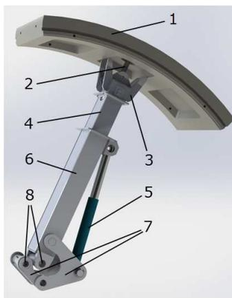
Рисунок 1 – Компьютерная модель рычага манипулятора с блоком
